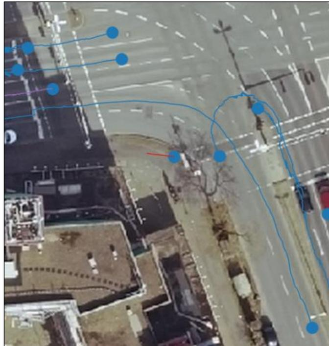
Abbildung 8: Visualisierung der kritischsten Interaktion im Süden der Kreuzung. Der Fußgänger (rote Trajektorie) beginnt mit dem Überqueren der Furt, während das Fahrzeug, das den U-Turn ausführt, die Furt im selben Zeitpunkt schneidet.
