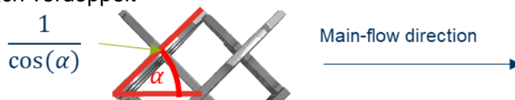
Abbildung 97: Veranschaulichung des geometrischen Faktors zur Erhöhung der Scheibenanzahl bei der Compartmentmodellerstellung
