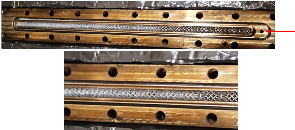
Abbildung 53 Geöffneter Halbschalenreaktor mit sichtbarer Belagsbildung.
