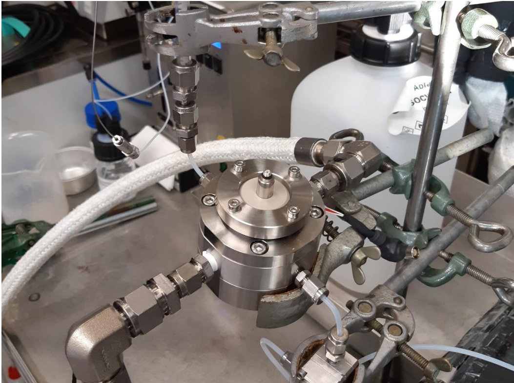
Abbildung 14 Die Messzelle V2 des Prototypens der ultraschallbasierten Messtechnik installiert in der Versuchsanlage bei Covestro am 11.02.2021
