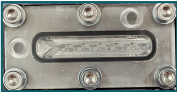
Abbildung 36 Kaskadenmischer 15 mit transparentem Deckel (links) und Schnitt durch den transparenten Deckel (rechts).
