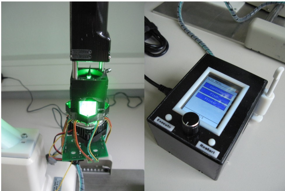
Bild 5 finale Ausführung des Beleuchtungsmoduls (links), Ansteuereinheit mit wählbaren Beleuchtungsmodi (rechts)
