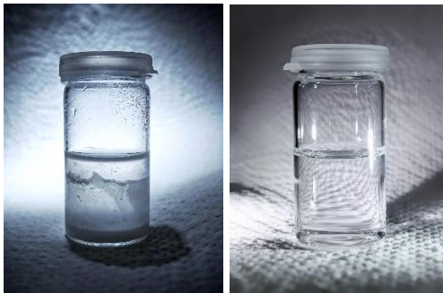
Abbildung 32: Proben von Sternpolymeren im Schmierstoff mit ungenügender (links) und ausreichender (rechts) Löslichkeit
