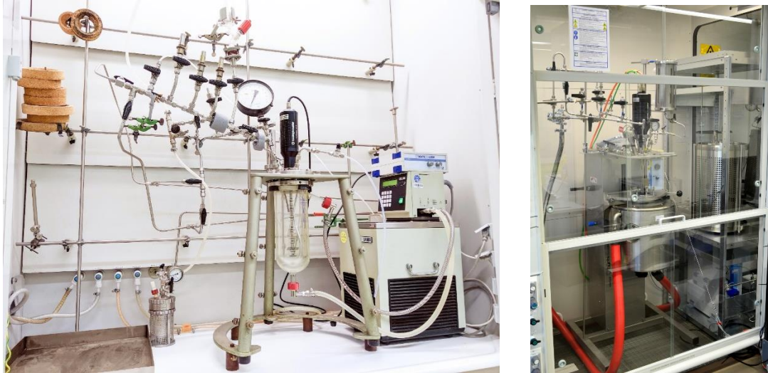
Abbildung 33: Reaktionsapparaturen zum Upscaling der Sternpolymersynthesen (links, 1,5 L, rechts 20 L)
