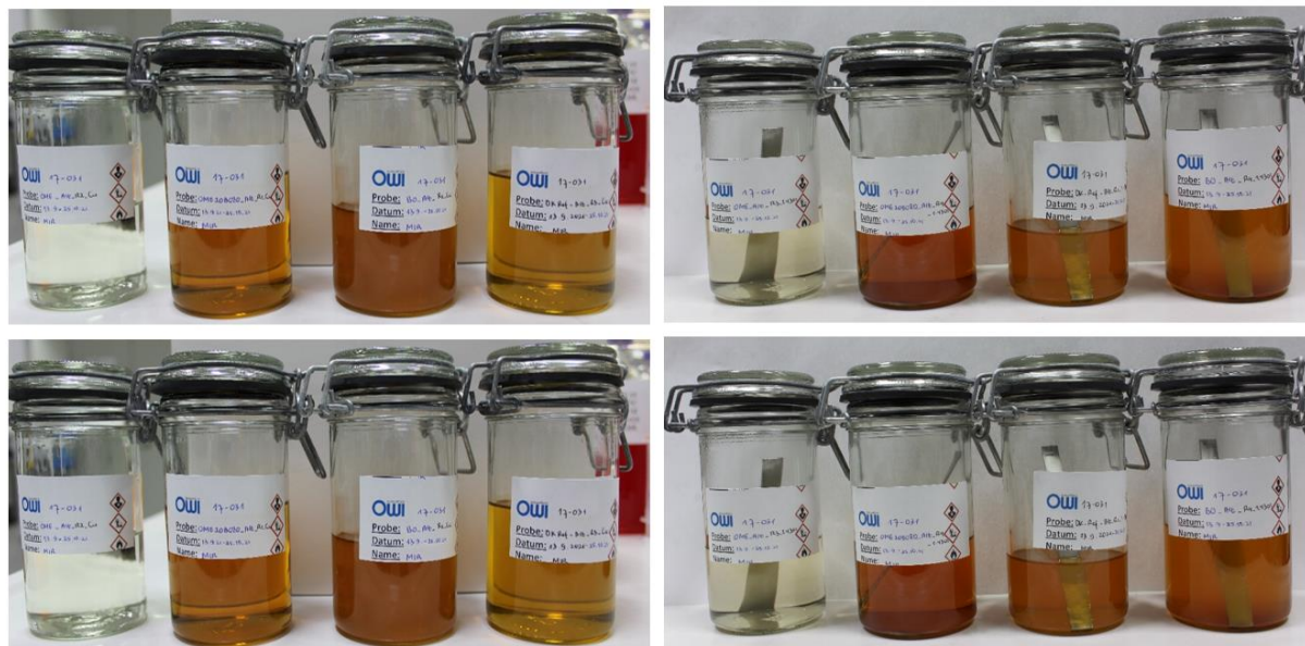
Abbildung 13: Bilder der Auslagerungsreihe mit Kupferstab (obere Reihe) und 1.4301 (untere Reihe): (links: Ursprungszustand vor Lagerung; rechts: nach Lagerung für 12 Wochen; Kraftstoffe von links nach rechts: OME-Kraftstoff, OME20, Diesel-B0, Diesel CEC-RF-06-03)
