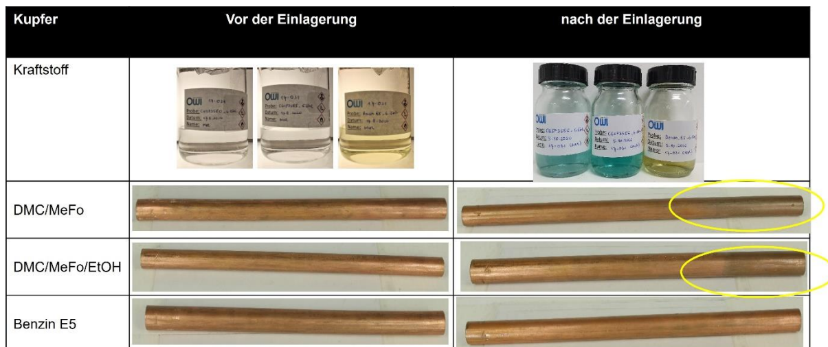
Abbildung 18: Immersionsversuche mit Kupferrohre
