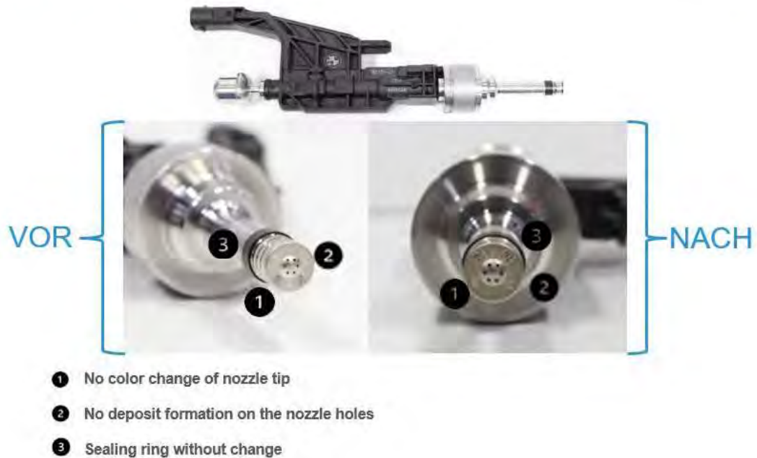
Abbildung 5: Befundung der Hochdruckinjektoren nach 9M Einlagerung in M100
