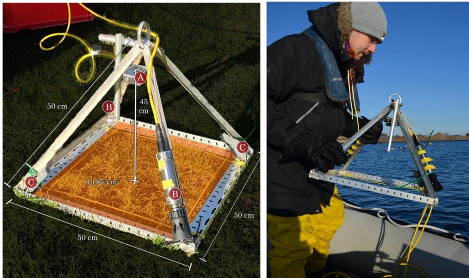
Abbildung 2: Links: Der Tetrapod mit integrierter Kamera (A) und Messgeräten (Temperatur, Salinität, Sauerstoff, B), Rechts: Einsatz des Tetrapoden vom Schlauchboot aus.
