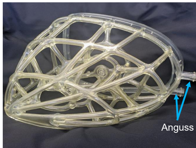
Abbildung 10 Stereolithografisch gefertigter Seitenaußenspiegel, Hohlstruktur
