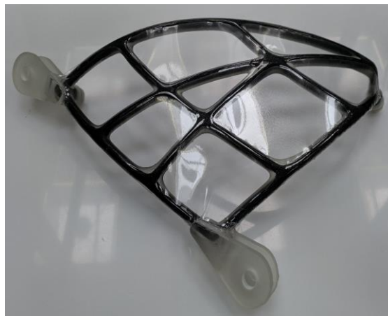
Abbildung 16 infiltrierte und mit Folie bespannte Prüfgeometrie
