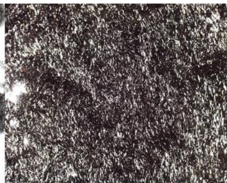
Abbildung 6 Mikroskopierte dispergierte Harz-Faser-Suspensionen
