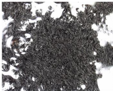
Abbildung 6 Mikroskopierte dispergierte Harz-Faser-Suspensionen
