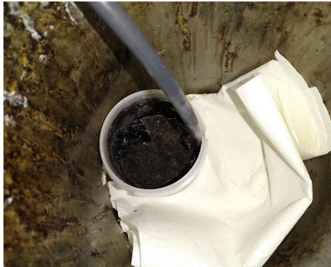
Abbildung 3 Versuch zur Überdruckförderung einer Harz-Faser-Suspension
