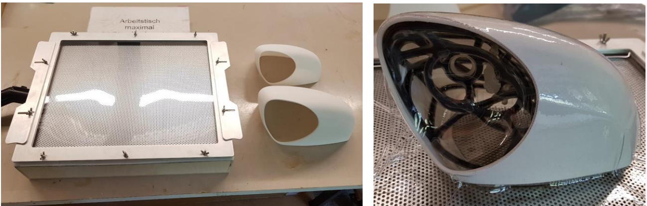
Abbildung 12 Tiefziehvorrichtung für die Hülle des Seitenaußenspiegels
