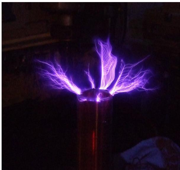
Abbildung 1-48: Koronaentladung in die umgebende Luft [1]
