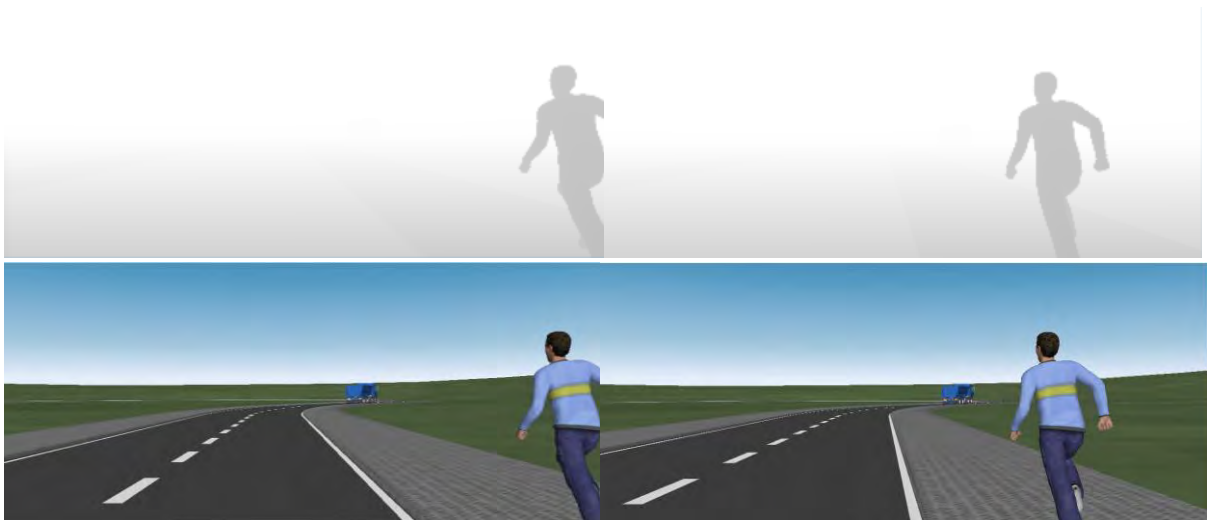
Abbildung 195: Ausgabe von Tiefeninformationen und von RGB-Bildern für eine Stereo-Kamera aus der CarMaker-Simulationsplattform
