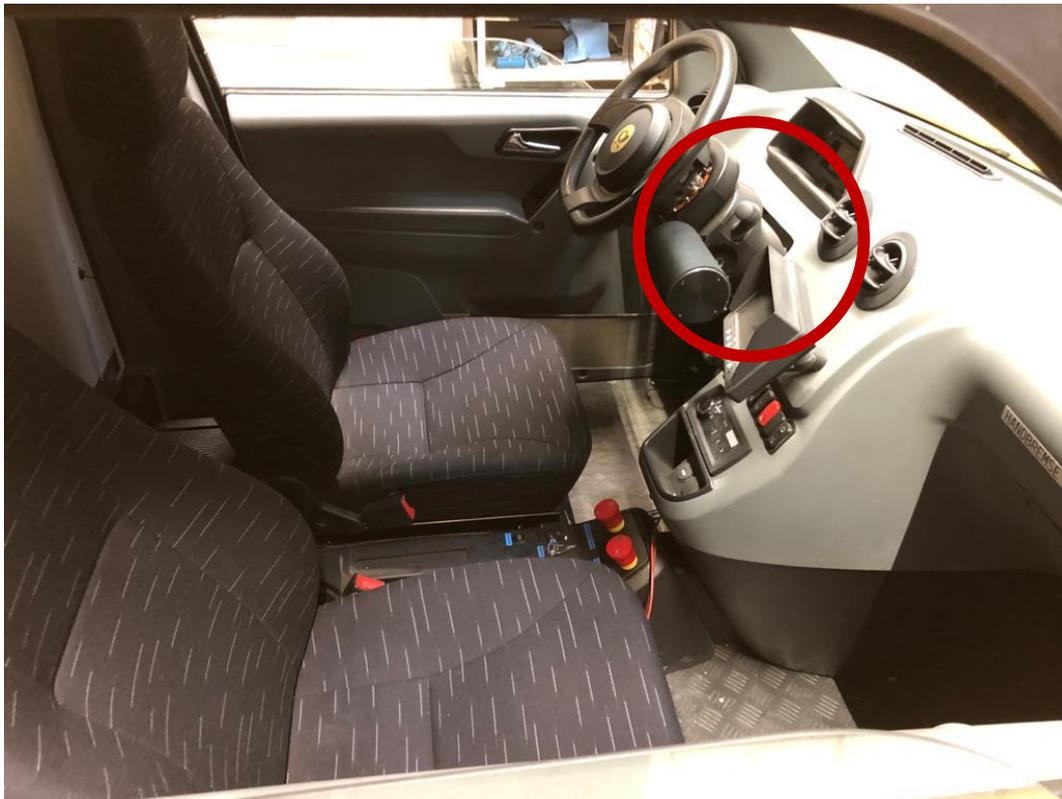
Abbildung 36: Aktor zur Umsetzung der automatisierten Fahrfunktion
