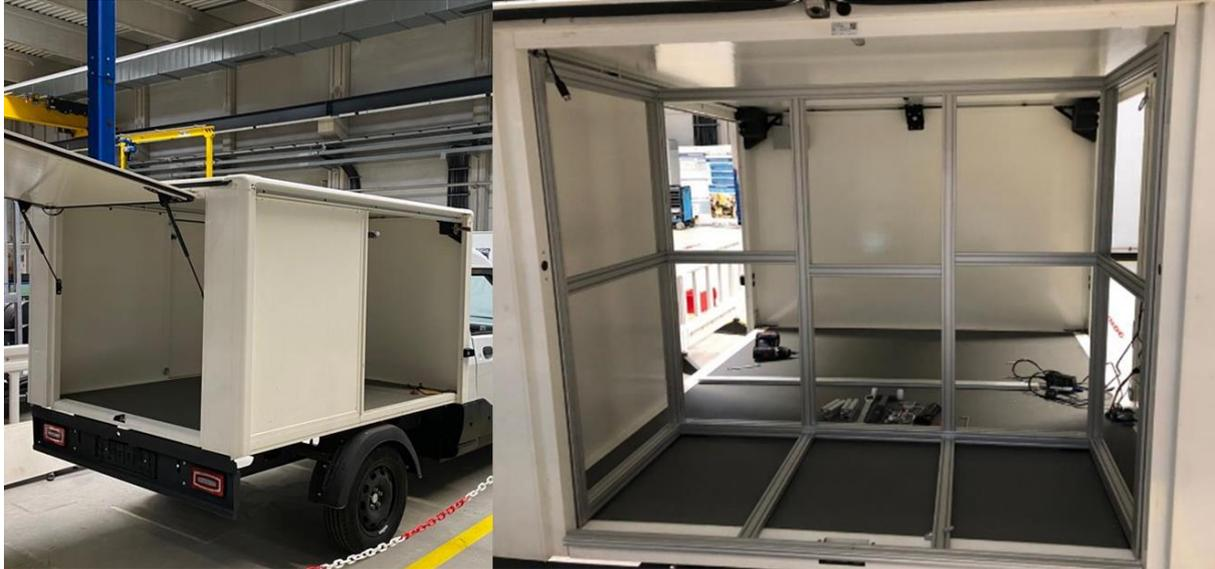
Abbildung 31: Integration der Packstückstruktur in das Fahrzeug.
