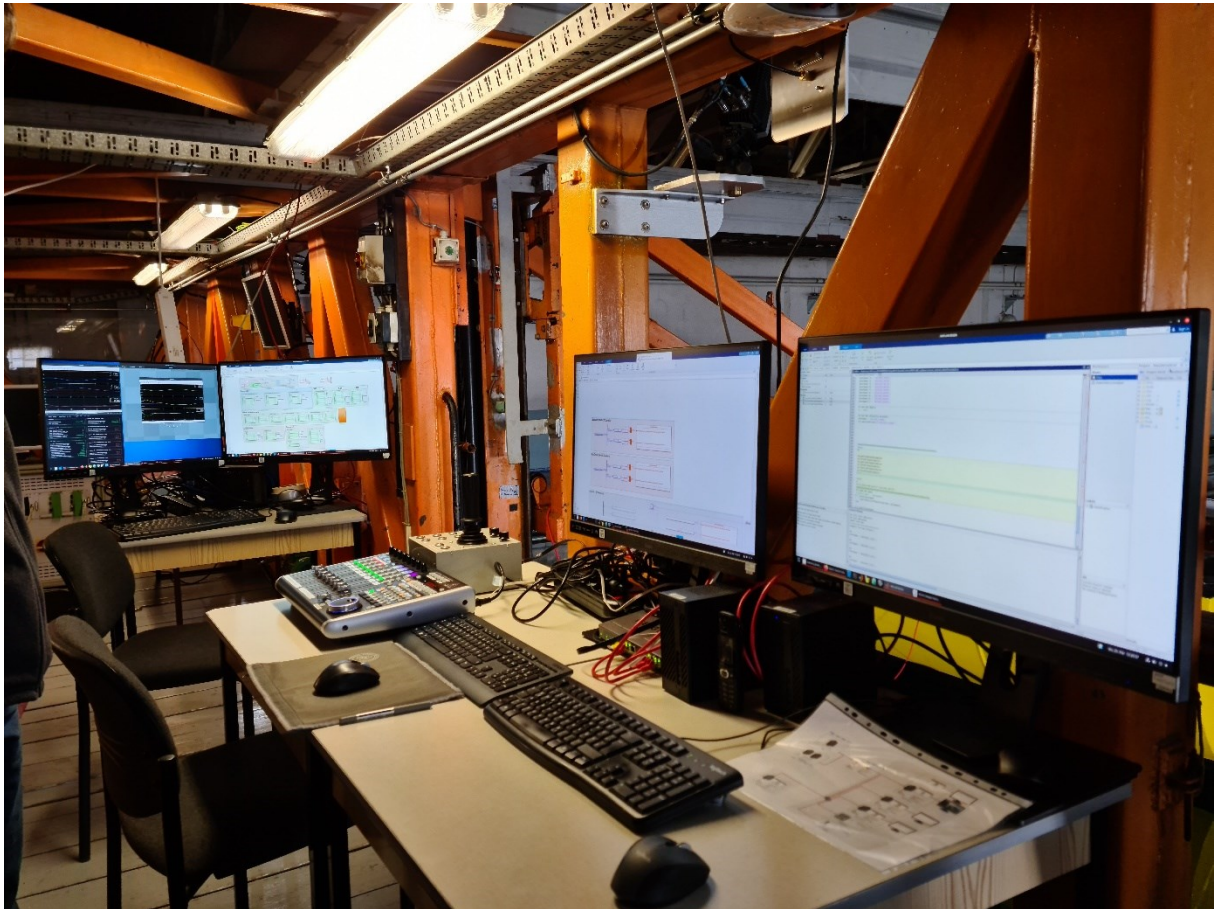
Abbildung 68 Aufbau des Entwicklungsleitstandes auf dem Schleppwagen des Schleppkanals der SVA Potsdam
