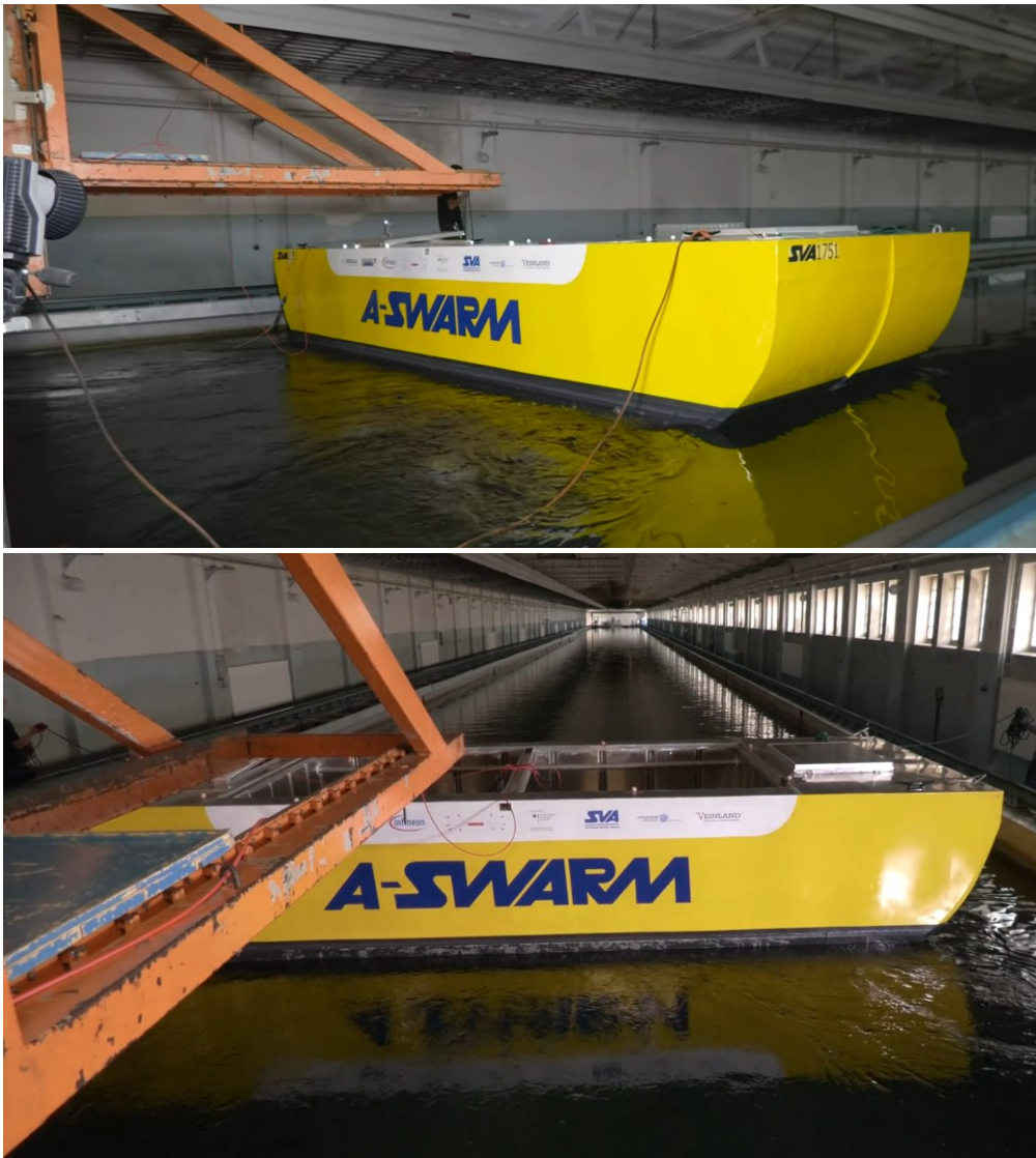
Abbildung 71 Fahrzeug während eines Identifikationsversuchs in Querfahrt im Schleppkanal der SVA Potsdam
