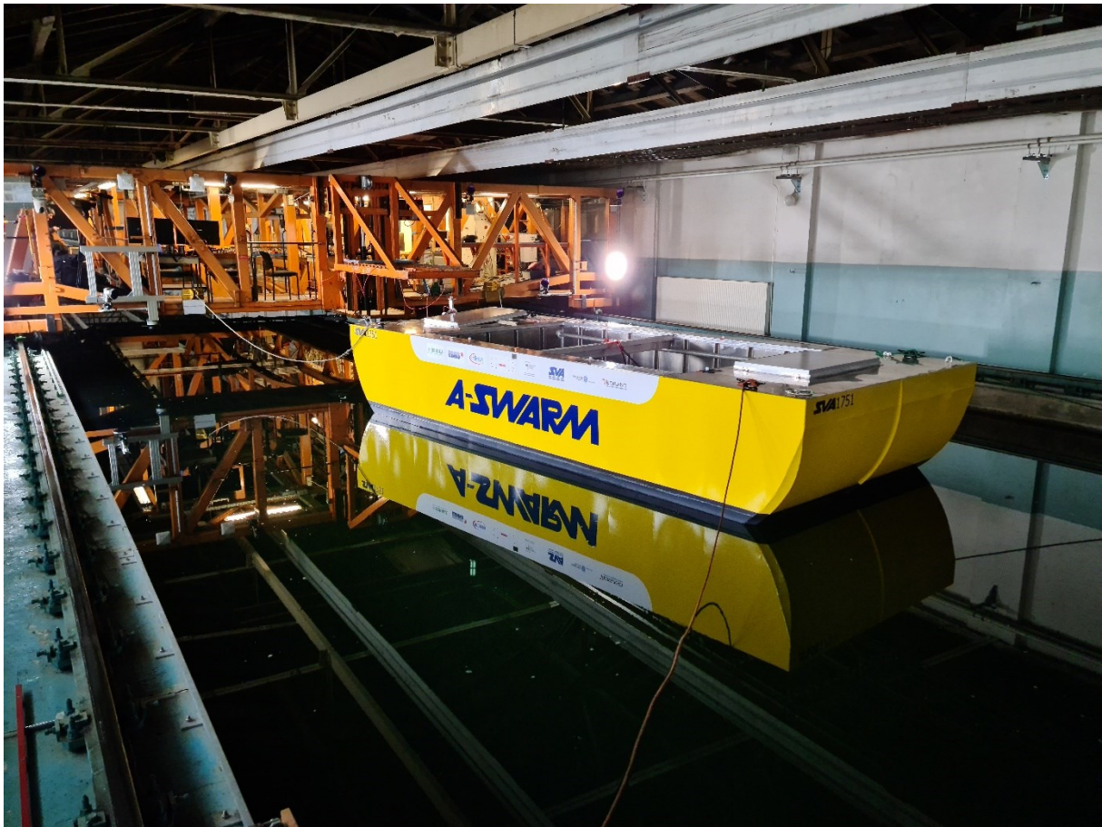
Abbildung 69 Messwagen und Fahrzeug im Schleppkanal der SVA Potsdam
