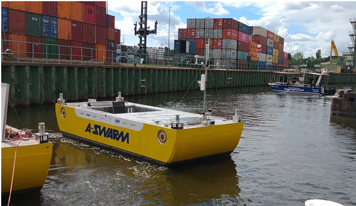
Abbildung 91 Ablegemanöver vom magnetisch gekoppeltem, zweiten Versuchsträger
