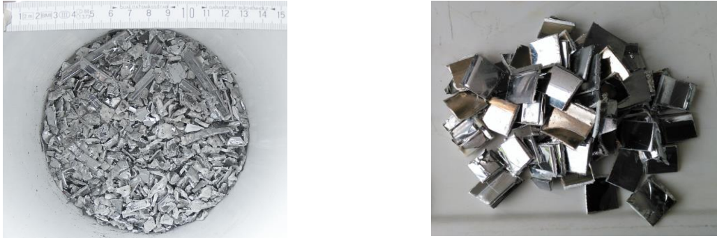
Abb. 2: Vorzerkleinerte Versuchsmaterialien 10 mm und 30 mm
