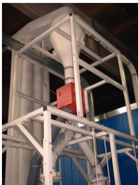
Abb. 9: Metalldetektor vor der Absackeinrichtung
