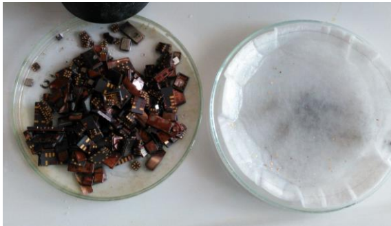
Abb. 3: RAM mit teilweise abgelöster Goldbeschichtung (rechts auf dem Filterblatt) und Cu-Ablagerungen auf den Bauteilen
