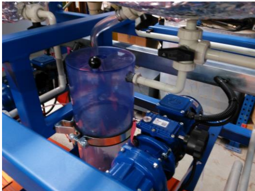
Abb. 2: Abtrenneinheit für die Metallflitter am Technikumsreaktor
