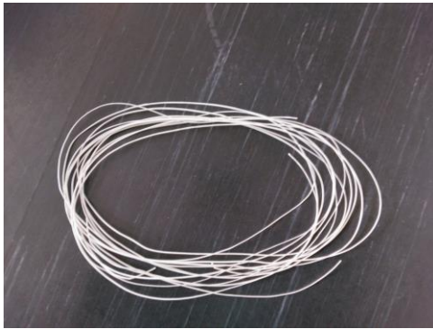
Abb. 11: Extrudierter Strang mit NOVODUR mit 20% Recyclatzumischung
