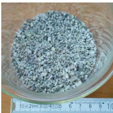
Abb. 10: Aufbereitetes Recyclat (Splittergranulat) vor der Verarbeitung im Extruder
