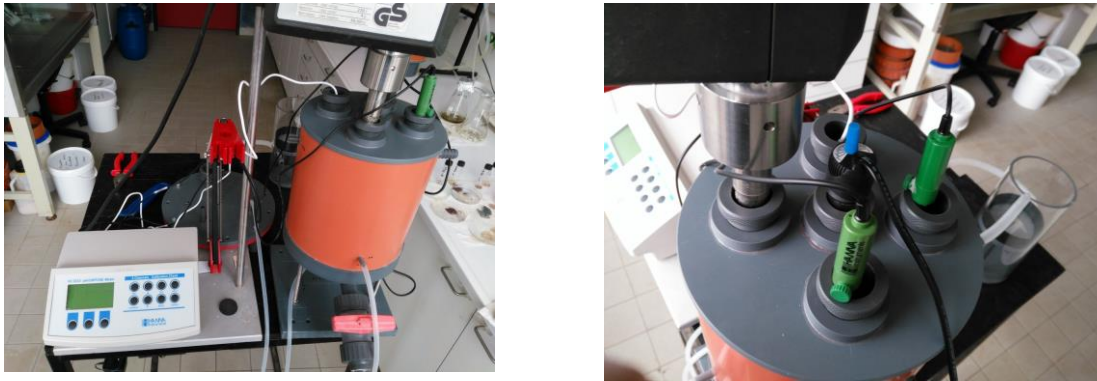
Abb. 9: Laugungsreaktor (links) und Deckel des Reaktors mit Heizstab, Messfühler für pH und Redox sowie Temperaturfühler (rechts)
