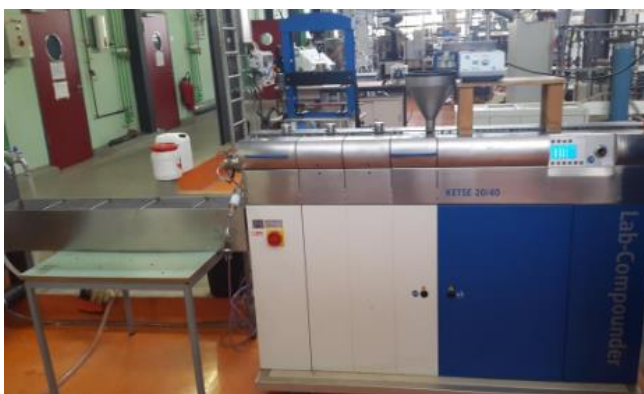
Abb.12: Laborextruder Brabender KETSE 20/40 mit Kühlbad
