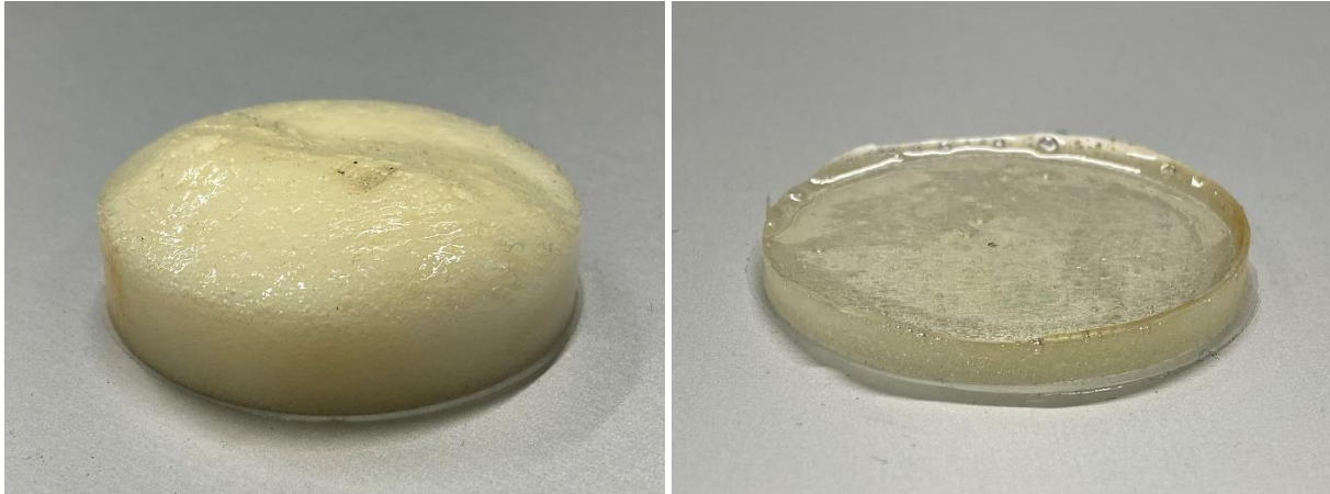
Abbildung 14: Simulierte Fehlstelle aus flexiblem Polyurethanschaum (links) und Epoxidharz (rechts) mit einem Durchmesser von 46 mm
