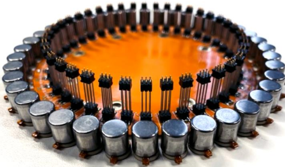
Abbildung 17: Circular-Ring Phased-Array mit Backing und flexibler Leiterplatte
