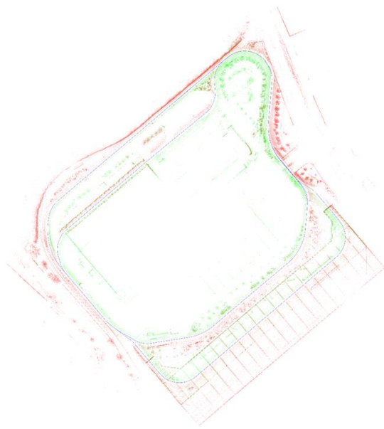
Abbildung 15: Beispiel Kartierung ViP Betriebs-hof "Cartographer" (unoptimiert). Die roten und grünen Punkte zeigen jeweils den verarbeiteten linken oder rechten Lidar. Bei genauer Betrachtung ist ein Offset zwischen Start- und Endpunkt zu erkennen, was auf eine sub-optimale Konfiguration zurückzuführen ist.
