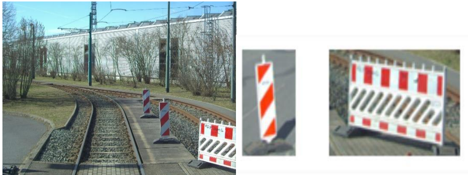
Abbildung 27: Ausschnitt aus der Datenbank „ai.store“ Links Beispiel eines Video-Streams. Rechts annotierte “Bounding Boxes” der beiden Kategorien ROAD_Verkehrsbake, und ROAD_Schranken­zaun.
