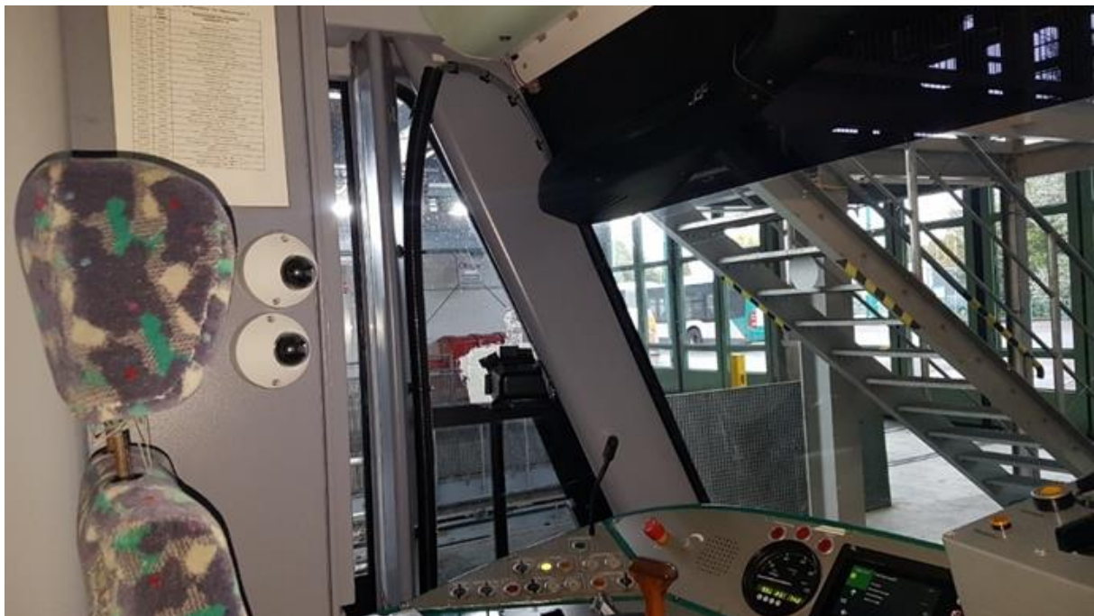
Abbildung 38: Position der Kameras im Fahrerstand
