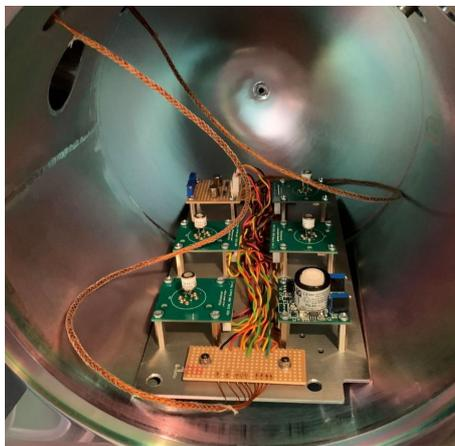
Abbildung 11: TVOC Sensor Testkammer
