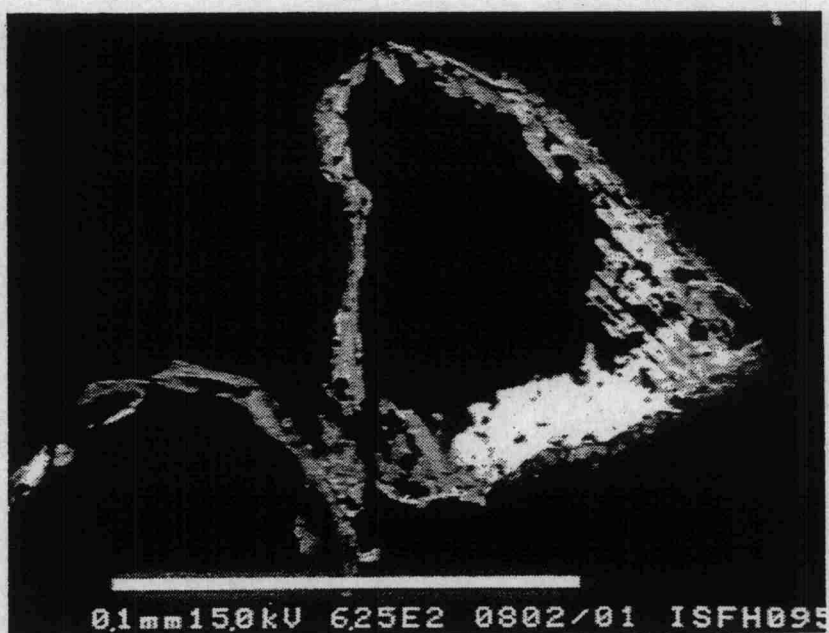
Abb.6 Einzelnes CdTe-Korn in einer Membran. Sekundärelektronen-Bild (oben) und EBIC-Bild (unten).
