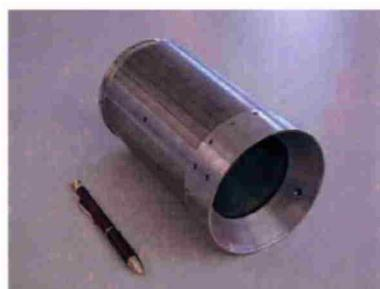
Bild 24: Magnethülse des Synchronmotors zur Integration am Rotor
