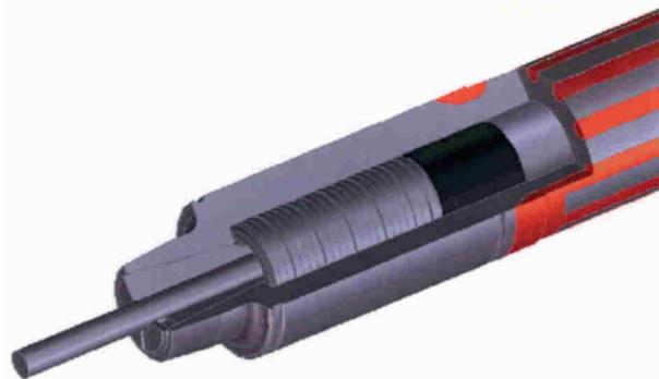
Bild 7. Präzisionsspannsystem für den Einsatz kleinster Werkzeuge
