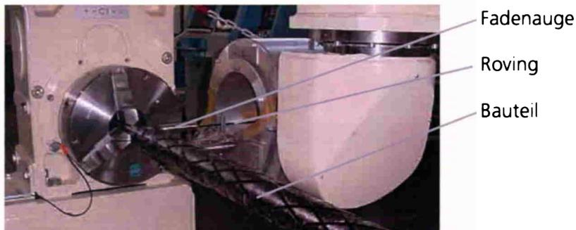
Bild 29: Wickeln des CFK-Rotors
