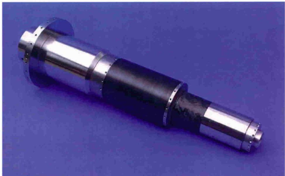
Bild 33: Endbearbeiteter Rotor der Schleifspindel
