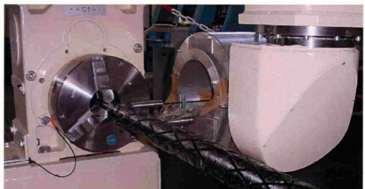
Bild 2. Wickelprozess von CFK-Rotorkomponenten
