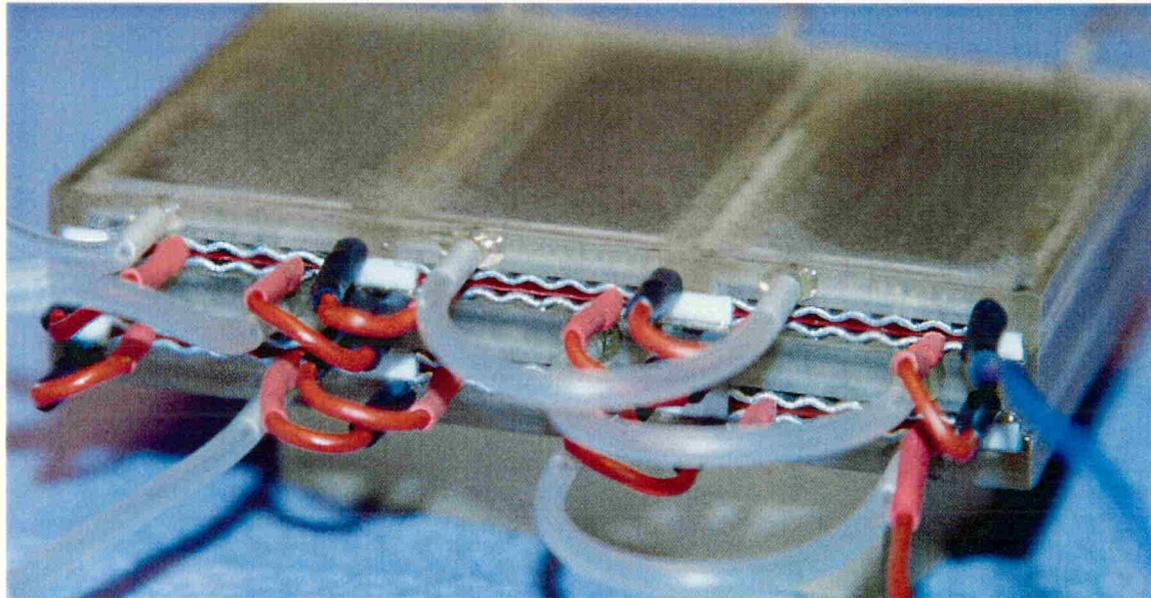
Abbildung: Schwierigkeiten einer externe Verschaltung und Gasversorgung der einzelnen Zellen
