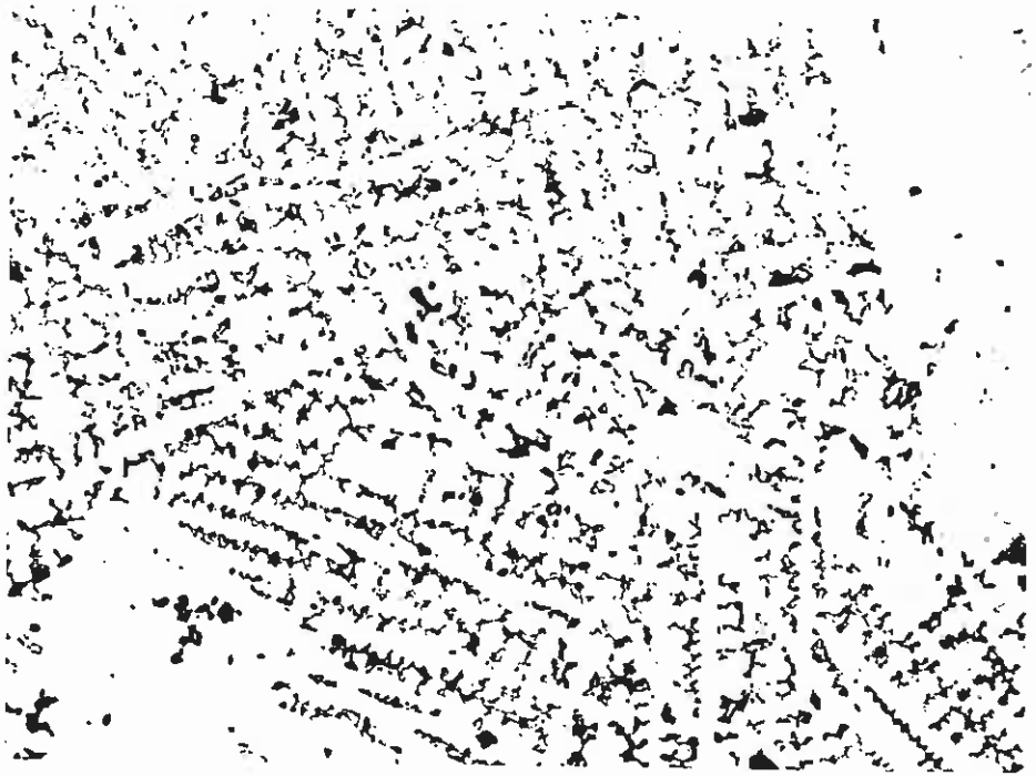
Abb. 118 Struktur der Porosität bei CuSn10 80 X
