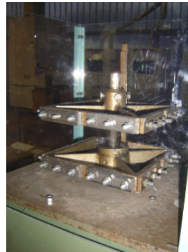
Abb. 12 ZWICK-Prüfstand für dynamische Messungen bei sinusförmiger Belastung
