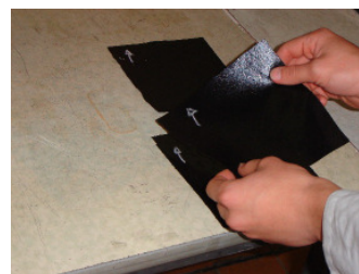
Abb. 4 Konfektion der Platten zur Gesamtdicke (entsprechend Werkzeug)
