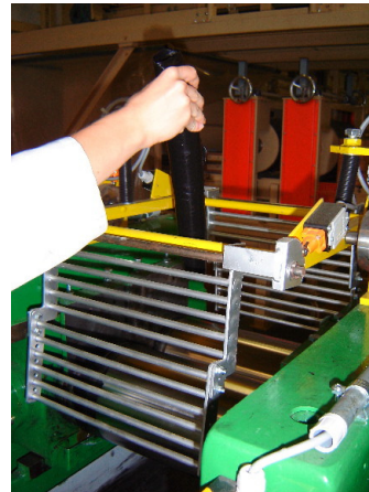
Abb. 2 Einmischen der Fasern – abschließendes Durchlaufen der Mischung bei definiertem Spalt
