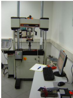
Abb. 12 ZWICK-Prüfstand für dynamische Messungen bei sinusförmiger Belastung
