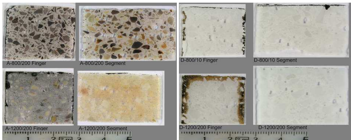
Abb. 22: Dünnschliffe der Finger und Segmente nach ihrer Prüfung mit AlMg5Na unter Verbrennungsatmosphäre.
