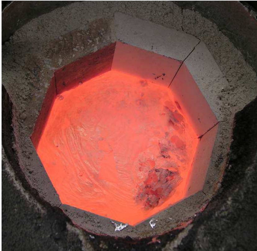
Abb. 9: Induktionsofenprüfung von segmentförmigen Probekörpern unter Luft bei 900°C. Die Prüfdauer beträgt 8 Stunden.
