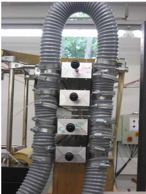
Abbildung 16: Luftzufuhr neuer Trockner und Kurzschlusschieber
