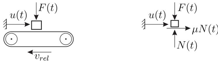
Abbildung 3.3: Zur Leistungsbilanz der Kontaktkräfte ( $v_{rel} > \dot{u}$ ).
