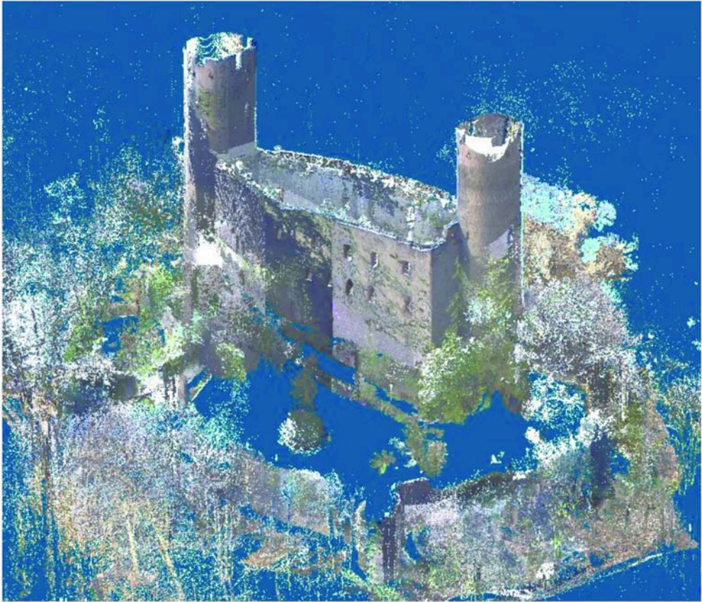
Abb. 6: Burg Andlau im Elsass. Diese 3-D-Repräsentation zeigt eine Fusion konventioneller photogrammetrischer Bilder mit Laserscanning-Punktwolken; Quelle: Landes et al. 2007.
