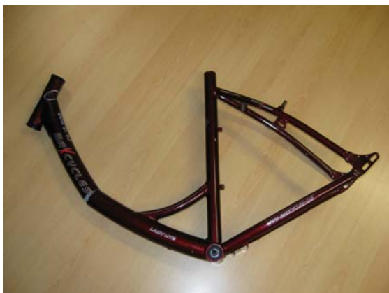
Abbildung 28: Beschädigungen am Rahmen nach der Schwebungsprüfung
