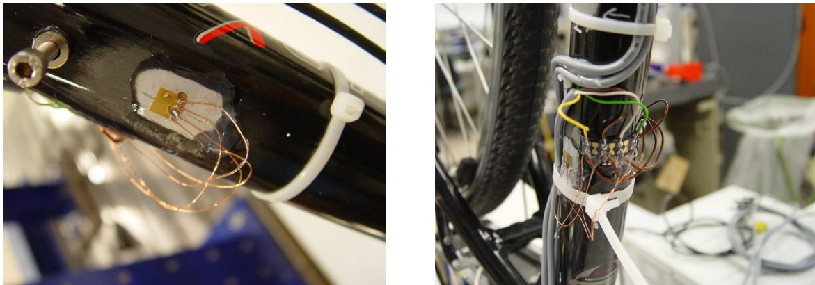
Abbildung 8: Mit DMS bestückter Einrohr-Rahmen (Abbildungen exemplarisch)
