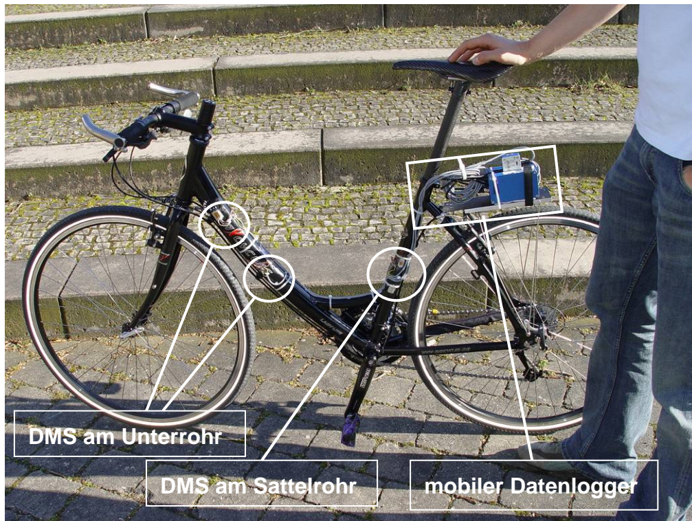
Abbildung 9: Messrad mit Datenaufzeichnungssystem
