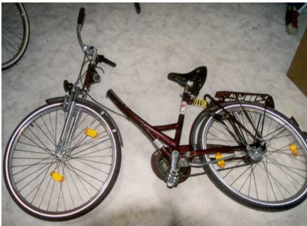
Abbildung 38: Bruch des Al-Hauptrohres eines Einrohrrahmens in der WEZ der Steuerkopfschweißnaht
