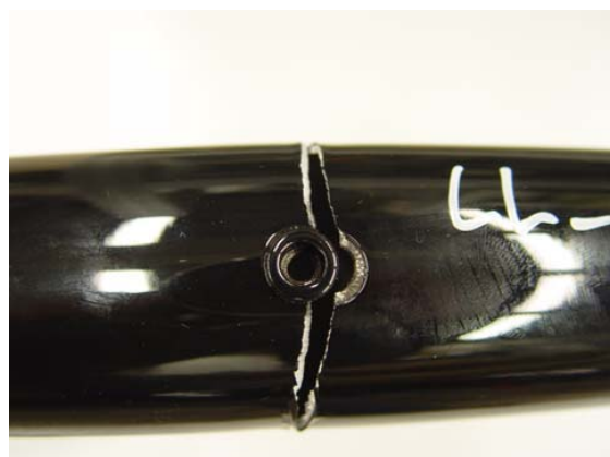
Abbildung 28: Beschädigungen am Rahmen nach der Schwebungsprüfung
