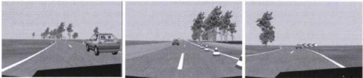
Abbildung 7-21: Beispielhafte Verkehrssituationen des Landstraßen-Parcours des Fahrsimulators des Würzburger Instituts für Verkehrswissenschaften (WIVW). Links: Überholen, Mitte: Baustelle mit Spurverengung, Rechts: Scharfe Linkskurve.
