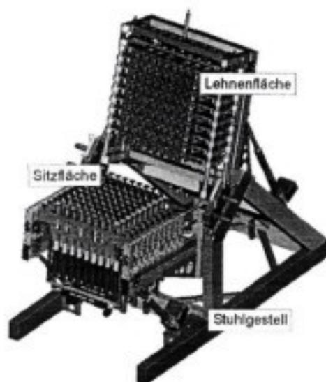
Abbildung 3: Forschungsstuhl zur Vermessung und Simulation von Sitzen
