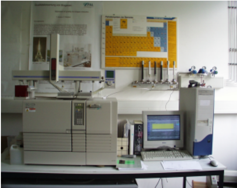
Abbildung 4: GC-MS-System zur Spurengasanalytik von Biogasgemischen
