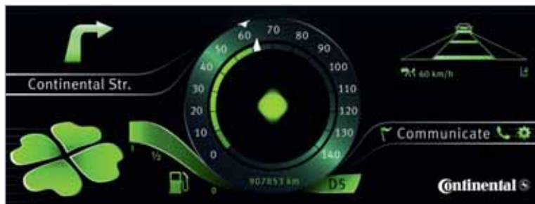
Abbildung 33: Display eines Eco-Profiles. Das teilautomatisierte Fahrprogramm unterstützt eine spritsparende Fahrweise. Quelle: Continental Automotive 2010.
