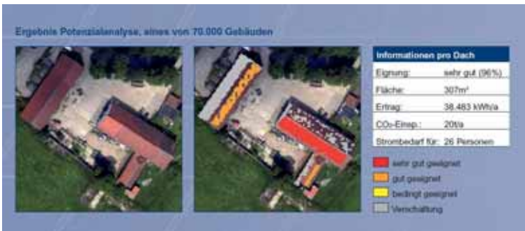
Abbildung 51: Ergebnis der Potenzialanalyse für eines von 70.000 Gebäuden der Stadt Osnabrück. Quelle: SUNAREA 2008.
