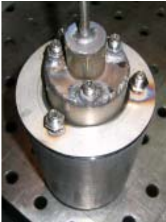
Abbildung 3-8: Fertigung des Membranreformers ohne Membran zur Untersuchung der Reformer-Brenner-Einheit
