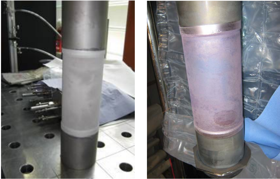
Abbildung 3-79: Membranrohr 1538 (links) und D2 (rechts) vor dem Einschweißen in den Reaktor
