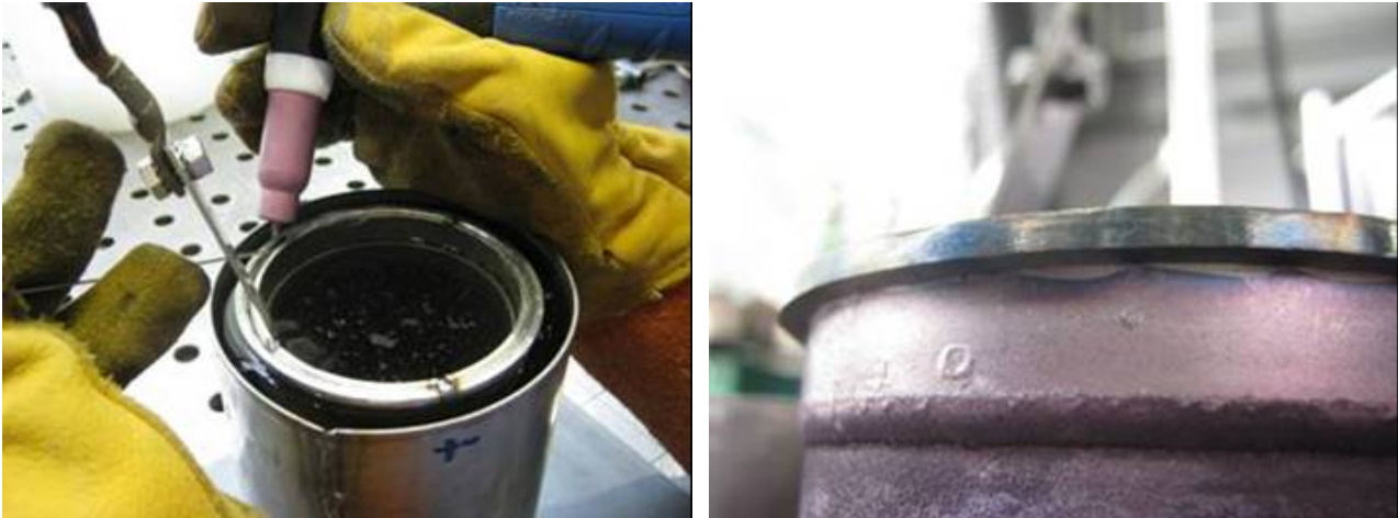
Abbildung 3-81: Einschweißen des Abstandsrings an das Membranrohr
