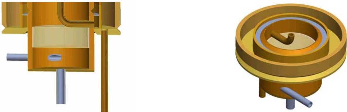
Abbildung 3-7: Detail des Membranreformerfußes
