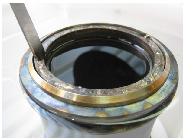
Abbildung 3-82: Einschweißen des Membranrohres in das Außengehäuse
