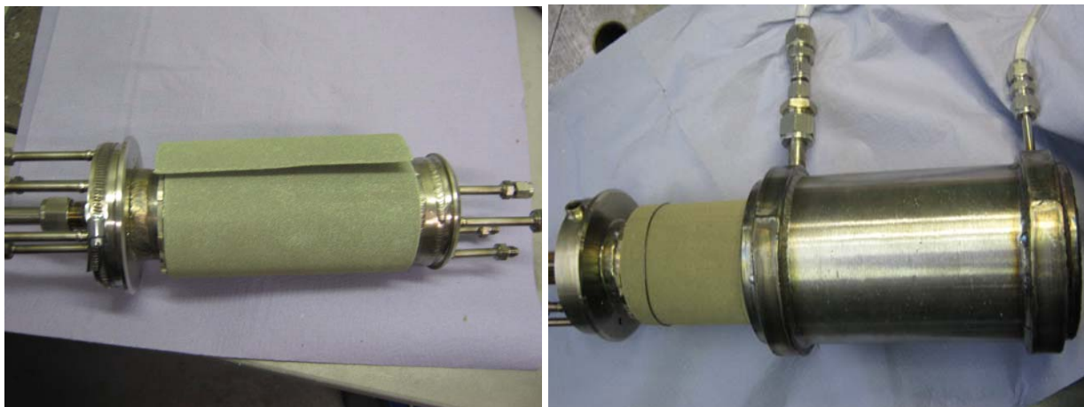
Abbildung 3-85: Einbau des Metallschaums
