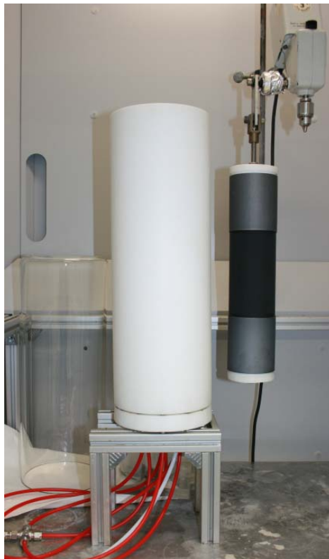
Abbildung 3-36: Apparatur aus Teflon zur Außenbeschichtung der Trägerrohre durch ELP und eine Trägermembran mit TiO 2 -Zwischenschicht montiert an einem Motor mit Exzenter.
