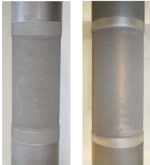
Abbildung 3-37: Die Trägerrohre mit Pd-Schicht: YSZ-Schicht (Probenbezeichnung 1603) links, TiO 2 -Schicht (Probenbezeichnung D1) rechts.
