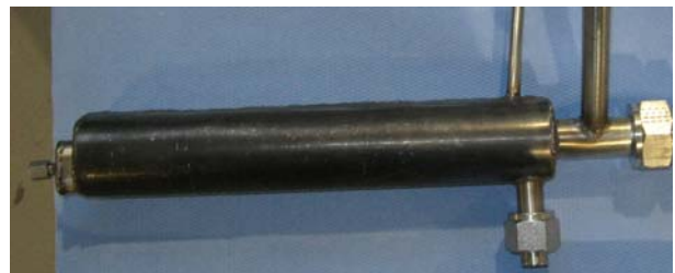
Abbildung 3-30: Kombinierte Verdampfung und Überhitzung mit Rauchgas
