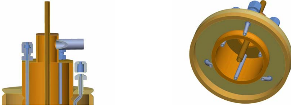
Abbildung 3-6: Detail des Membranreformerkopfs
