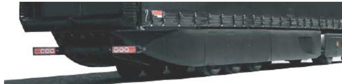
**Abb. 5.49: Vollverkleidung des Aufliegerunterbaus [28]**
