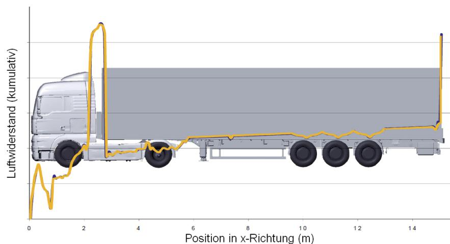
**Abb. 5.1: Luftwiderstandsentwicklung entlang eines Sattelzugs [6]**
