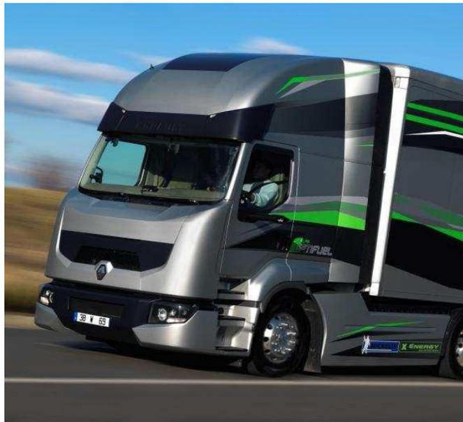
**Abb. 5.7: Vermeidung der Strömungsablösung durch vergrößerte Frontradien [58]**
