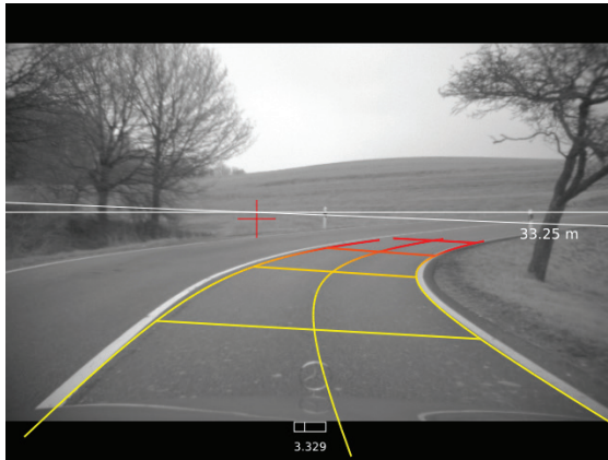
(a) In der Darstellung des Ergebnisses im Kamerabild ist der Höhenverlauf der Kurve farblich kodiert. Durch den Übergang von gelb nach rot wird der Anstieg verdeutlicht.
