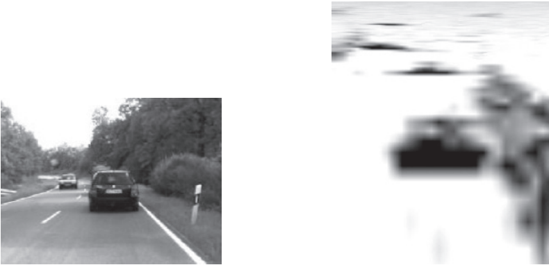
Abb. 2.10.: Objekterkennung: Neben dem direkt vorausfahrenden Fahrzeug werden auch die im Kamerabild links verdeckten Fahrzeuge angemessen. Die Radarstrahlen werden von der Straße reflektiert und erst von dem entfernten Fahrzeug zurückgeworfen. Diese Fahrzeuge sind in den Radarmessdaten rechts deutlich zu erkennen. Bildquelle: [Mei03].
