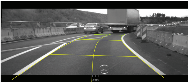
(b) Auf der Gegenfahrbahn führt der Verlauf in eine Rechtskurve.
