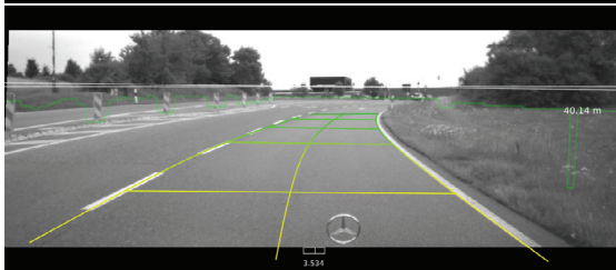
Abb. 6.9.: Ergebnis der Straßenverlaufsschätzung bei kleiner Systemvarianz für den Parameter der Straßenbreite: Die Straßenbreite bleibt nahezu konstant.
