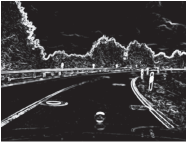
(c) größerer Eigenwert: Durch die Eigenwerte des Strukturensors lassen sich Ecken von Kanten unterscheiden. Wird der größere der beiden Eigenwerte dargestellt, so heben sich Straßenmarkierung und andere Kanten von Flächen mit uneinheitlicher Struktur ab.
