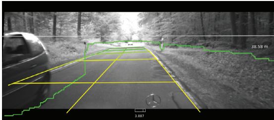
(a) Geschätzter Straßenverlauf: Ein Teil der Straße liegt nicht im berechneten Freiraum.
