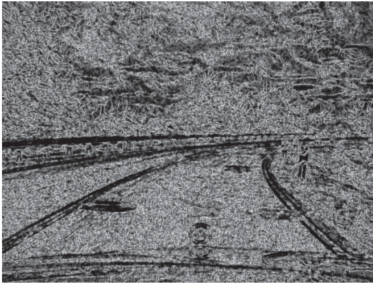
Abb. 5.2.: Detektion von Kanten: Bei einer Kante ist der kleinere Eigenwert des Strukturtenors nahe Null, der größere hat einen hohen Wert. Der Quotient aus dem kleineren durch den größeren Eigenwert nimmt dort sehr kleine Werte an, bei anderen Strukturen treten größere Werte auf.
