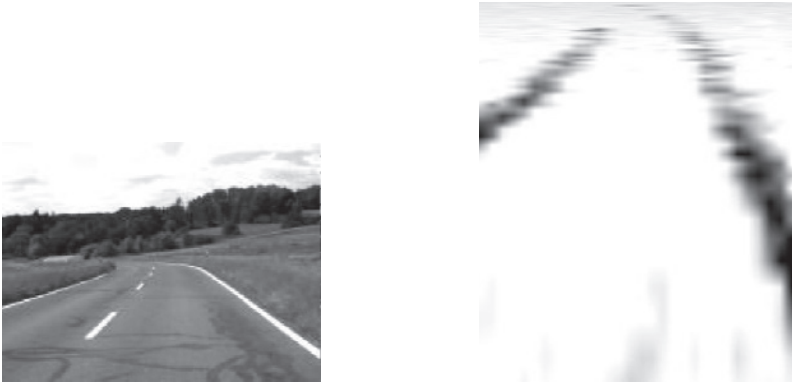
Abb. 2.9.: Radarbasierte Straßenverlaufserkennung: Das hohe Gras am Straßenrand reflektiert die Radarstrahlen. Anhand der Messdaten rechts kann der Straßenverlauf detektiert werden. Bildquelle: [Mei03].
