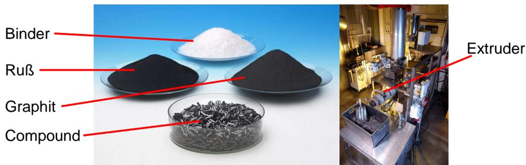
**Abbildung 4: Bestandteile der graphitischen BPP, Compound und Extruder**
