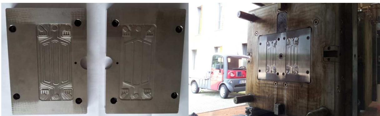
**Abbildung 28: Überarbeitetes Formeinsatzpaket einzeln (links) und montiert (rechts) im Zweikavitäten-Spritzgießwerkzeug**
