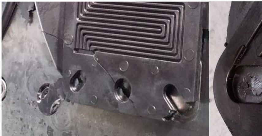
**Abbildung 29: Risse, Ausbrüche und Haftung auf falscher Seite bei 1. Spritzgießtests**
