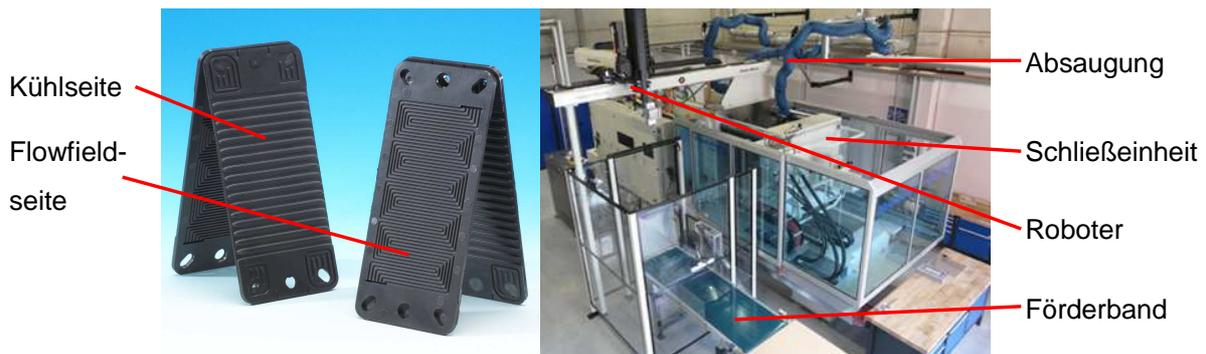
**Abbildung 5: Bipolarplatte aus Compoundmaterial sowie Spritzgießmaschine**
