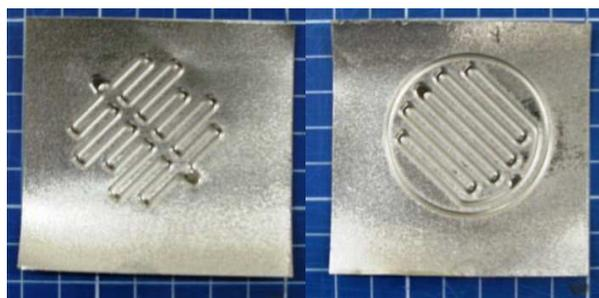
**Abbildung 7: Metallisches Substrat einer Brennstoffzelle, Fa. Gräbener**
