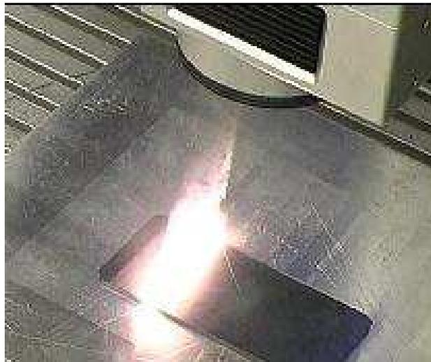
**Abbildung 33: Laserbehandlung einer Bipolarplatte**
