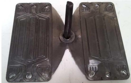
**Abbildung 30: Spritzgegossene Bipolarplatten im 2-Kavitätenmodus mit Anguss**
