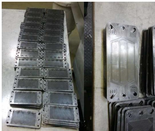
**Abbildung 31: Spritzgegossene, projektspezifische Bipolarplatten**
