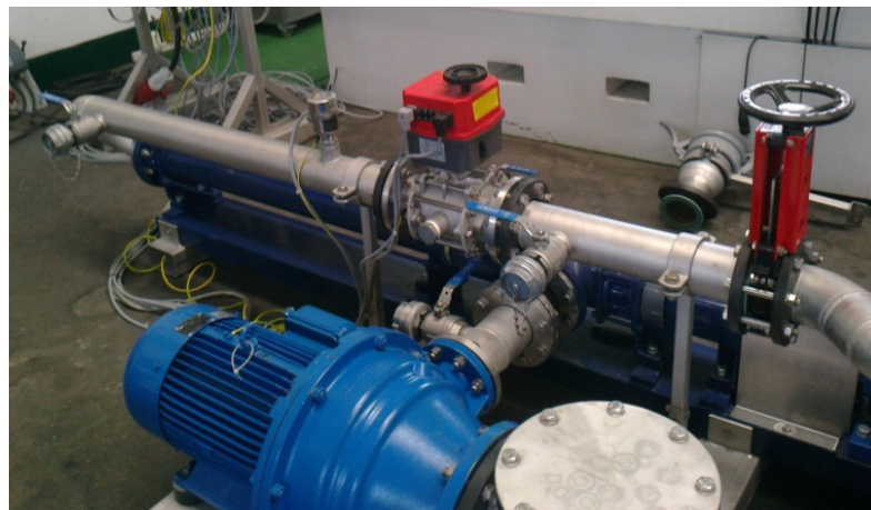
Abb. 3: Versuchsanlage zur mit optimierter Düsengeometrie im Piltomaßstab.
