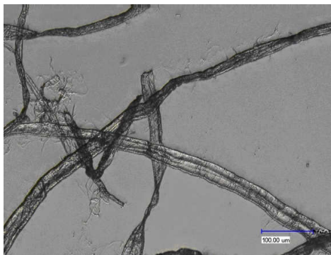
Abb. 12: Lichtmikroskopie von Langfaserzellstoff unbehandelt (links) und nach Kavitationsbehandlung ( Q=50 l/min, SD=0,6\% ).
