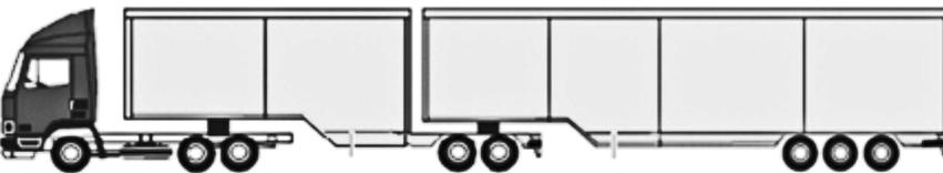
4. Sattelkraftfahrzeug mit einem weiteren Sattelanhängen bis zu einer Gesamtlänge von 25,25 Metern
