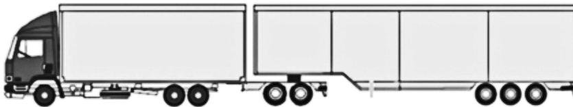
3. Lastkraftwagen mit Untersetzachse und Sattelanhängen bis zu einer Gesamtlänge von 25,25 Metern
