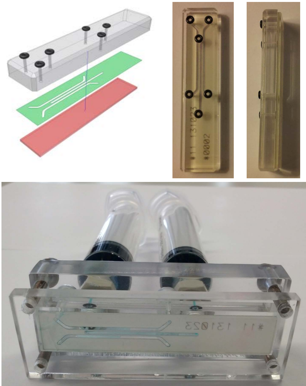
Abb. 28: Explosionsdarstellung (oben links), leere (oben rechts) und teilweise befüllte 3-Kanal-Flusszelle (unten).
