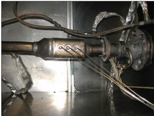
Bild 3.7: Prüfling mit Temperatur-Messstellen auf dem Brennerprüfstand
