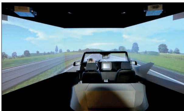
Bild 3: Der Fahrsimulator der BAST, Fahrzeug-Mockup und Darstellung der Strecke über drei Leinwände (Foto: Hardy HOLTE)
