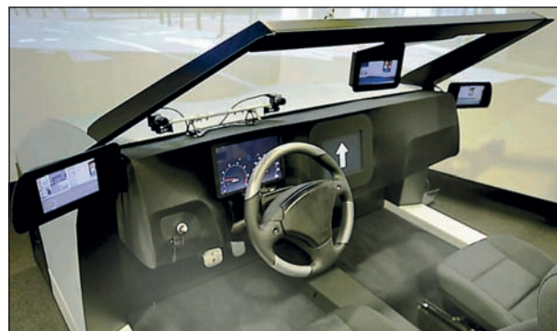
Bild 2: Fahrzeug-Mockup des BAST-Simulators. Neben den Sitzen, Pedalen und dem Lenkrad sind die Displays für den Rück- und die Seitenspiegel erkennbar. Auf dem Armaturenbrett sind die beiden Kameras für das Blickerfassungssystem Facelab angebracht. In der Mittelkonsole ist das Touchdisplay verbaut (weißer Pfeil), auf dem in dieser Studie die Nebenaufgabe dargestellt wurde (Foto: Hardy HOLTE)
