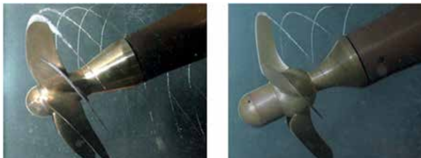
Abb. 7: Propeller des Einschraubers (links) und des Zweischaubers (rechts) bei Anströmwinkel \alpha=25^\circ und Fortschrittgrad J=0,6
