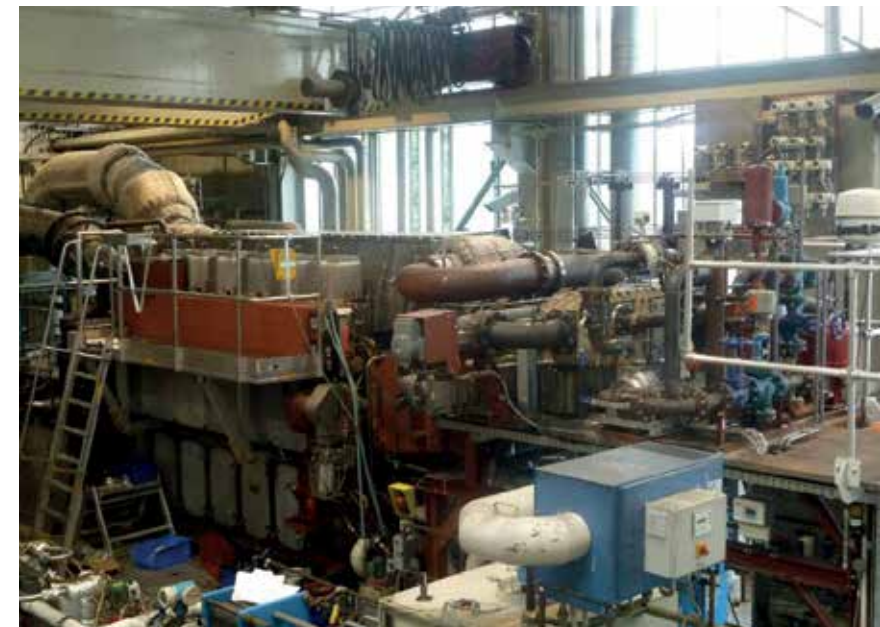
Abb. 5: MaK 6 M 32 Versuchsmotor mit 2-stufiger Aufladung und Abgasrückführung
