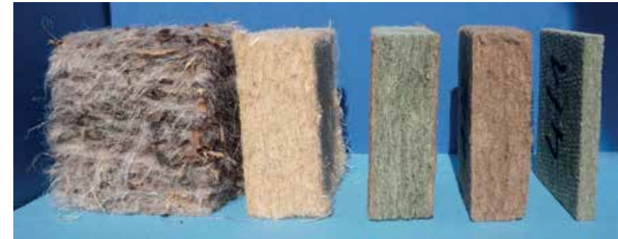
Abb. 2: Verschiedene Bindertypen (v.l.) aus Seegrass und Hanf, Holzfaser sowie Holzfaser mit verschiedenen Zusatzstoffen (Quelle: Technische Universität Dresden, Institut für Holz- und Papiertechnik)
