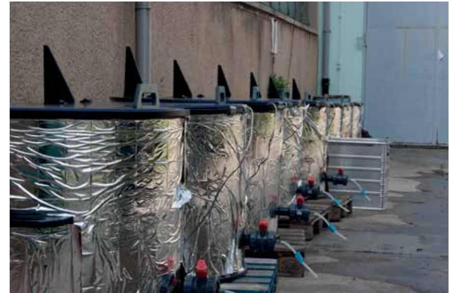
Abb. 6: Rundtanks (eingepackt in Rettungsdecken zur Verhinderung einer unnatürlichen Erhitzung) für Mesokosmenversuche mit integriertem Probennehmer (roter Auslaufhahn) und verschiedenen Messgeräten im Alucontainer
