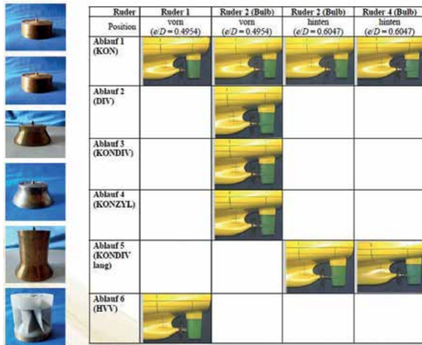
Abb 1: Testprogramm der verschiedenen Kombinationen aus Ablaufhaube und Rudergeometrie innerhalb der Voruntersuchungen
