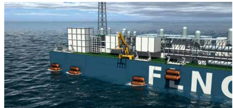
Abb. 1: Das SOTLL Flüssiggastransfersystem in Erwartung des Shuttle-Tankers
