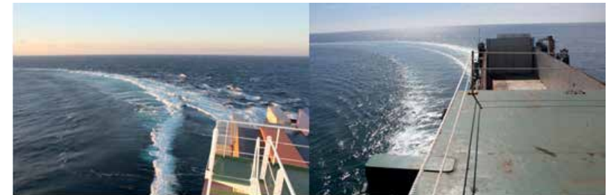
Abb. 3: Drehkreisversuch: Heckwasser des Einschraubenschiffes (links) und des Zweischraubenschiffes (rechts).
