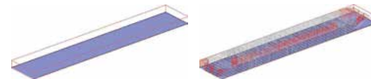
Abb. 1: Diskretisierung der Wasseroberfläche durch eine rechteckige Grundfläche (links) und mit neuem, flexibleren Gitter (rechts).
