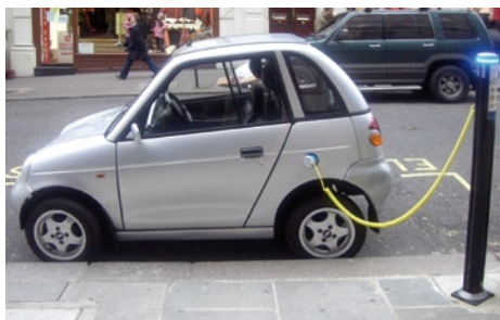
Stromtankstelle in London: Angepasste Maßstäblichkeit; Minimierung Kabellänge; Integration in bestehende Stadtmöblierung und die gestalterische Linie der Stadt; Quelle: Transport for London (Hg.), 2010.
