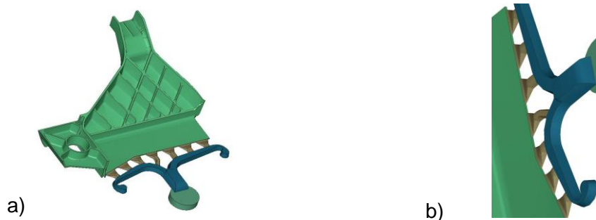
Bild 31: Geometrie mit nachkonstruiertem Angussystem. a) Karosserieknoten mit Angussystem, b) Angussystem
