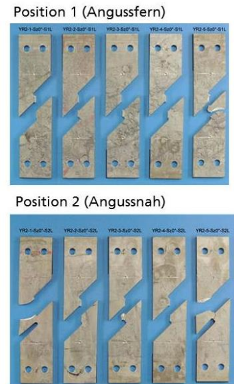
Bild 65: Scherzugproben \theta=0^\circ nach Versuch aus Position 1 und 2
