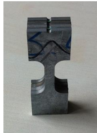
Bild 22: Entnommene Zugproben für Mikro-CT-Scans
