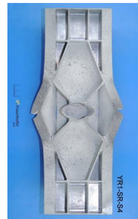
Y-box nach Stauchversuch
