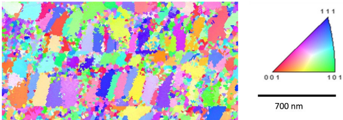
Abbildung 5-15: EBSD Abbildung einer Germanium-Nanostruktur. Die unterschiedlichen Farben entsprechen unterschiedlichen Kristallorientierungen.
