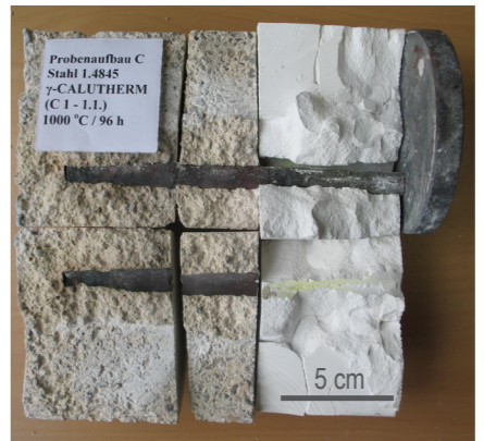
Aufgesägte Probe nach einem Korrosionszyklus im Gradientenofen
