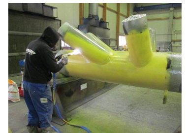
Beschichten des Demonstratorbauteils mit PA12-Pulversystem
