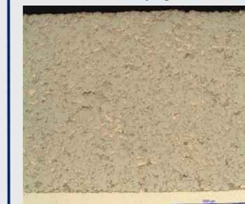
Bild 3: SPS gesinterte Schicht mit 90% recyceltem polykristallinem WC auf einem Stahlsubstrat.
