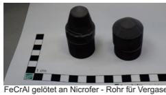
FeCrAl gelötet an Nicrofer - Rohr für Vergasertest
