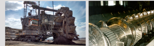
Bild 1: Typische Anwendungen für den Einsatz auftragsgeschweißter Hartverbundschichten - Tageabbagger für die Kohleförderung (links), Extruderschnecke für die Polymerverarbeitung (rechts)
