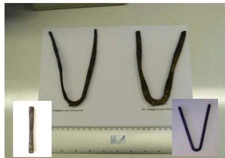
Stahlanker nach 2 jährigem Einsatz, Vergleichsmuster und nach Tiegeltest
