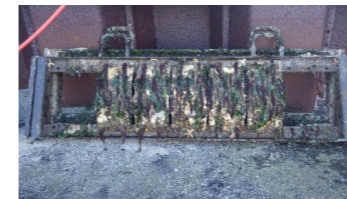
Beschichtete Probe nach der Auslagerung
