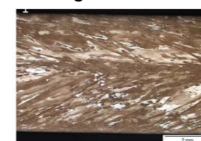
Schliffbild Mikrostruktur ZAX210 WR im gießgewalzten Zustand
