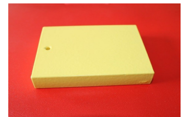
Beschichtete Stahlprobe mit großer Wandstärke
