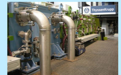
Hochleistungs-PVD-Quelle (blaue Kammer) in der Bandpilotanlage (Quelle: eigenes Foto)
