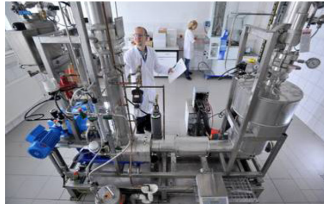
Der Pilot-Schleifenreaktor der Miltitz Aromatics GmbH als Pilotanlage für Hydroformylierungen. Quelle: Miltitz Aromatics GmbH, im Dezember 2015
