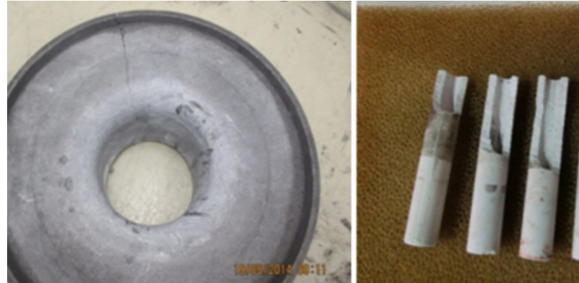
Abb. 1: Transition plate (AWW, 2015) und Gießdüsen (TRIMET, 2015) mit Rissen bis Bruch nach Al-Guss
