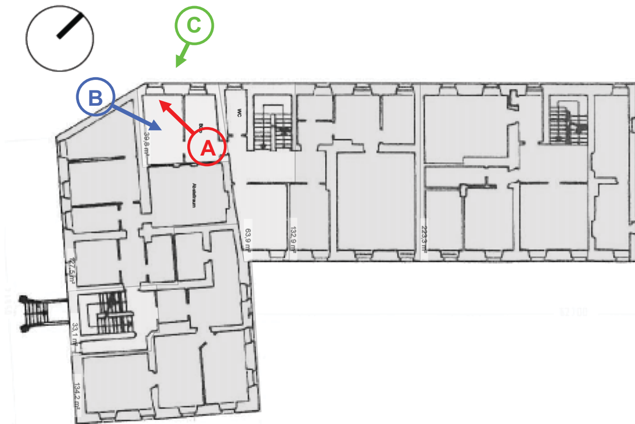
Abb. 73 Untersuchungsbüro im OG des Beamtenhauses – Grundriss mit Messpunkten Messpunkt A Oberflächentemperatur der Innenseite der nordwestliche Außenwand 1x normale Außenwand 1x dünne Außenwand / Fensterische Messpunkt B Raumklima Untersuchungsbüro Messpunkt C Außenklima St. Marienthal
