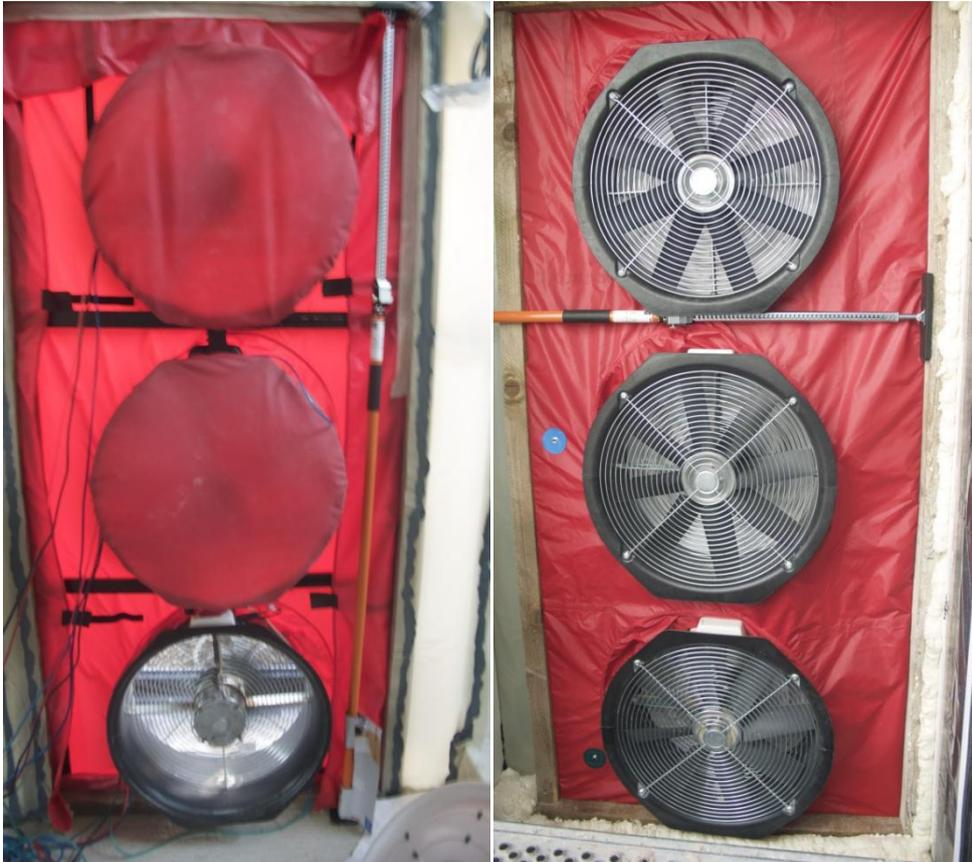
Abbildung 25: Ventilatoren zur Erzeugung von Unter- bzw. Überdruck für die Durchführung des Blower-Door-Tests
