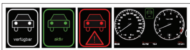
Bild 36: Symbole für die Anzeige des Systemzustands (links) und die Darstellung im Cluster Display (rechts)
